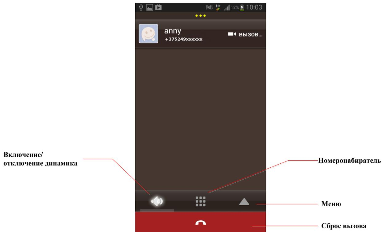
3. После ответа другой стороны устанавливается соединение как показано на [Рис.2-23](#).
